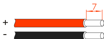
Figura 3-35 Spelare i fili di ingresso della stringa fotovoltaica (unità: mm)
