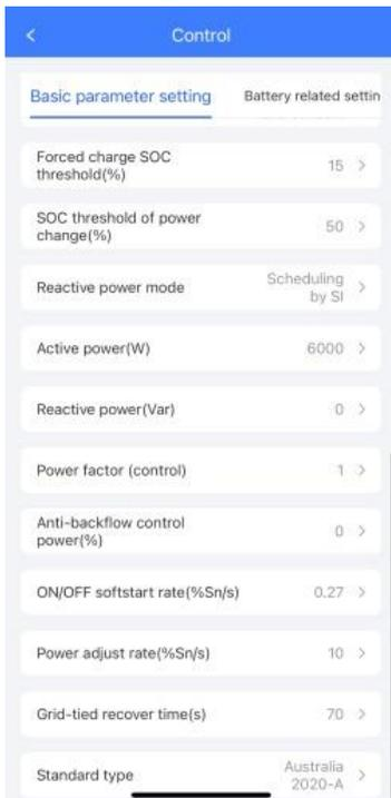
Figure4-11 Basic parameter setting
