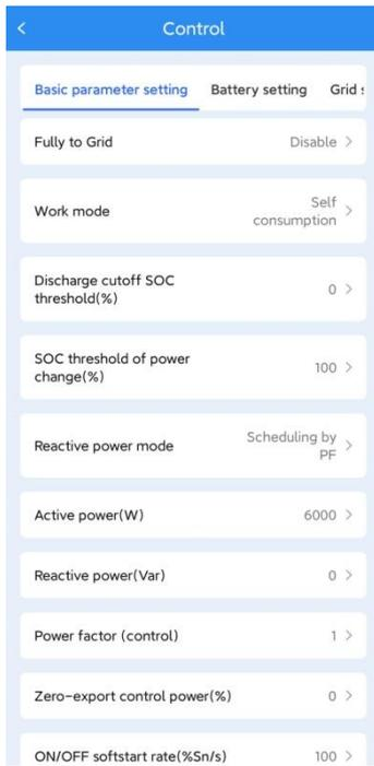
Figure4-18 Basic parameter setting
