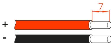
Figura 3-30 Schema di strippaggio dell'ingresso CC (unit à mm)
