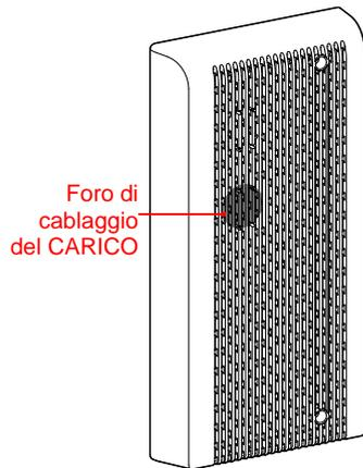
Figura 3-39 Escludere il foro del CARICO
